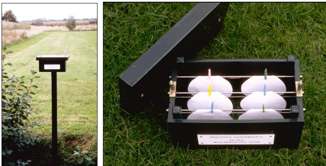
Figuur B2-3 Links een 'fluoridenkastje' in het veld en rechts een bovenaanzicht van het kastje met de geïmpregneerde filtreerpapiertjes.
