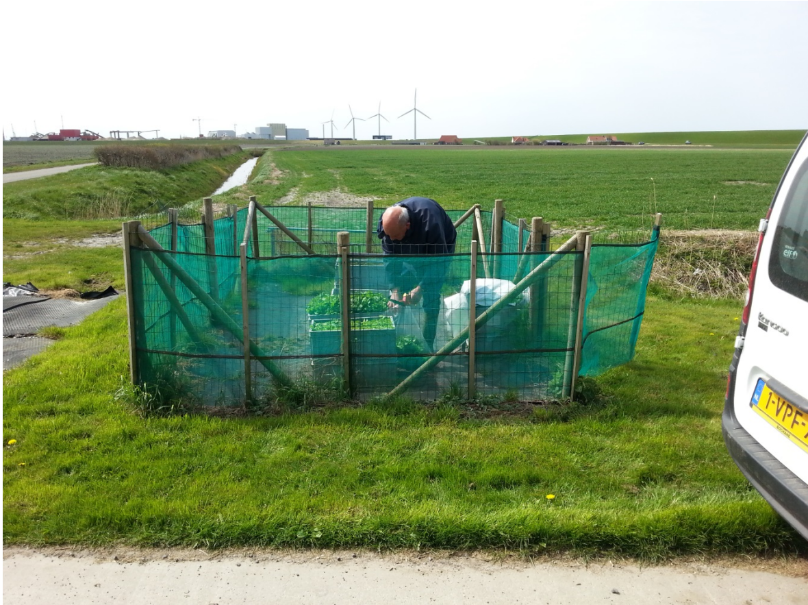
Figuur 2-2 Meetpunt 1 van het biomonitoringprogramma met op de achtergrond de REC. Oppervlakte van circa 20 m 2 , afgezet met windbreekgaas en vrij 'zicht' in de richting van de REC. Tijdstip: mei 2013, op moment van de eerste spinazieoogst.
