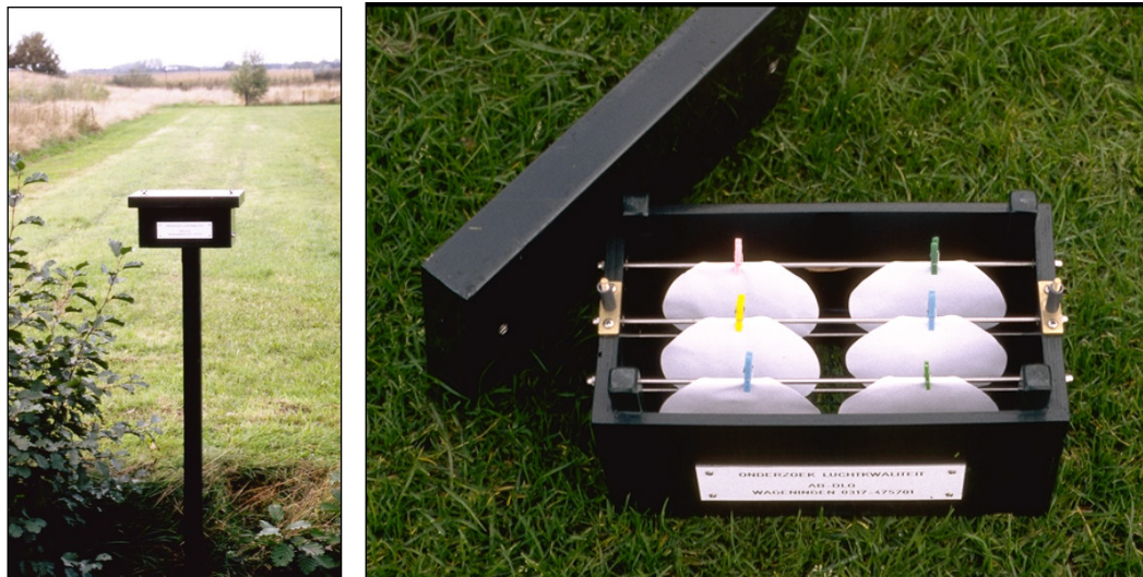
Figuur 2-3 Links een 'fluoridenkastje' in het veld en rechts een bovenaanzicht van het kastje met de geïmpregneerde filtreerpapertjes.
